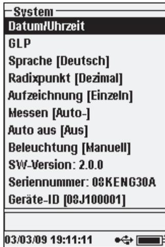
Aus dem Systemmenü können Sie auf die Einrichtungsoptionen des Instruments zugreifen, unter anderem: **Datum/Uhrzeit, GLP, Sprache, Radixpunkt, Protokollierung, Probenentnahme, automatische Abschaltung, Hintergrundbeleuchtung, SW-Version, Seriennummer und Geräte-ID.** Die aktuellen Einstellungen für ein Element werden in [Klammern] eingblendet. Im Beispiel links auf der Seite ist der Radixpunkt derzeit auf [Dezimal] eingestellt.
