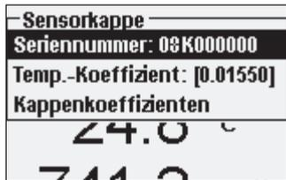
**Sensorkappe** ermöglicht das Anzeigen und Eingeben von spezifischen Informationen für die auf dem Messfühler installierte Sensorkappe. Markieren Sie „Sensorkappe“, und drücken Sie auf die Eingabetaste, um die Seriennummer der Sensorkappe, den Temperaturkoeffizienten und die Sensorkappenkoeffizienten anzuzeigen. Diese Informationen werden im Werk in den Sensor einprogrammiert und an das Instrument gesendet,
